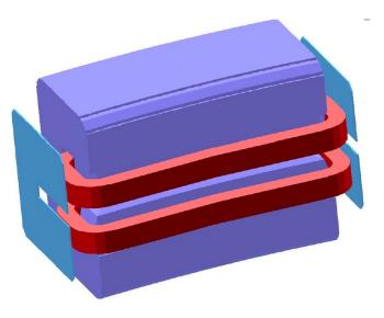
Example: le dipole de l'anneau de soleil. Etude magnetostatique 3d n/ref. : dsm/dapnia/sacm/soleil-2002
