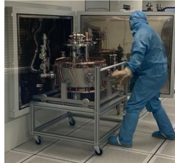
RFQ en cuivre pur Cu2, réalisé en fabrication additive métal (I-FAST)
