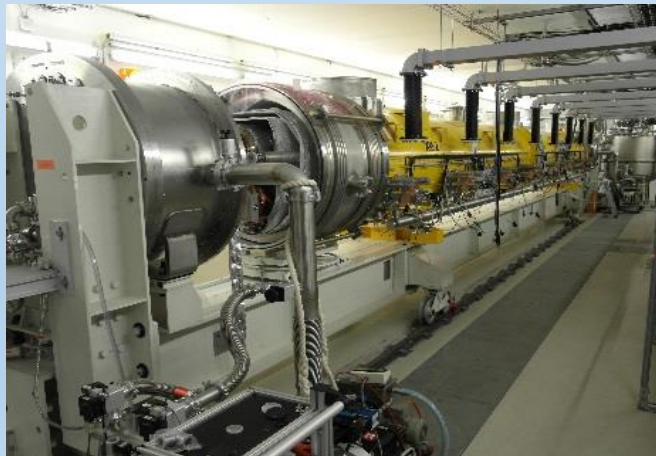
Cryomodule test stand – module inside
