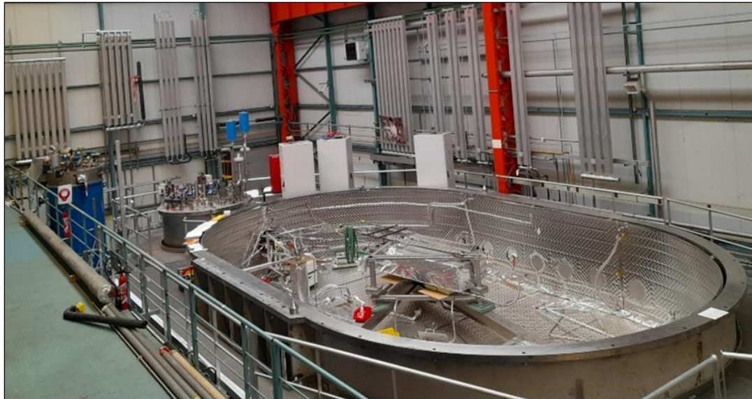
Cryostat MATTRICS : 12 x 7 x 1,8 m
