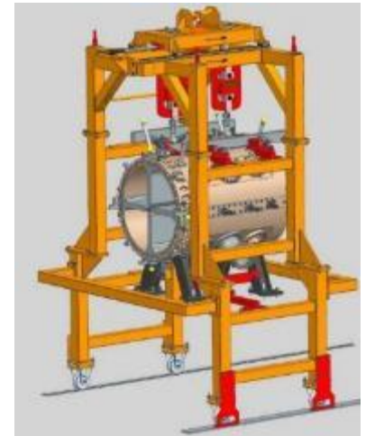
Outil d'assemblage RFQ avec une précision de \pm 20\mu\text{m}
