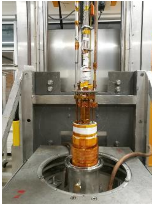
Insertion de l'aimant dans le cryostat de Grenoble
