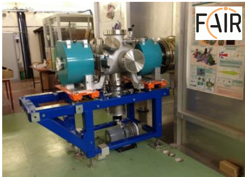
Ligne de transport de faisceaux à basse énergie pour le linac à protons FAIR au CEA Saclay
