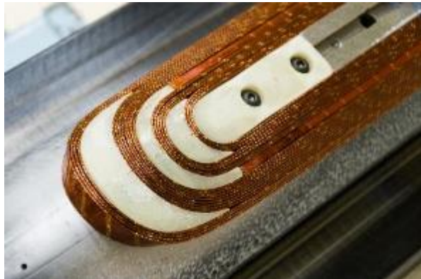
Détail d'une tête de bobine pendant le bobinage
