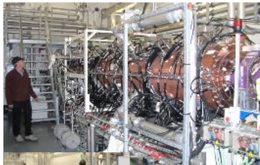
RFQ et son système de refroidissement
