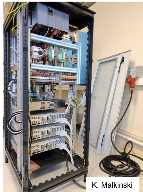
Mise aux normes CEM du banc de mesure de perte d'énergie des particules alpha N. Karkour, L. Gibelin
