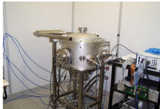
Connections, câblage, fabrication de bride pour l'étuve sous vide ...
