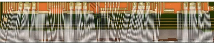
710 wirebonds (aluminium 25 \mu m) per quad module
