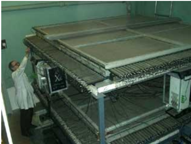
Barreaux de scintillateurs croisés + PMTs
