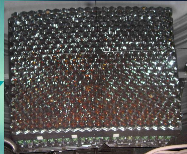
caméra à 440 PMT 1.5° par pixel
