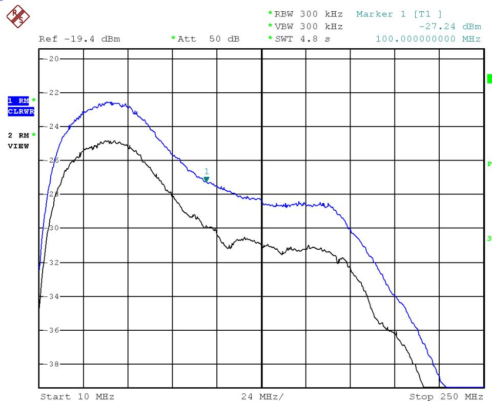
Trace bleue= 50R+ LNA+7m50R + Att 6DB + 2 Ampli inter + 0,5m 50R + Mixer + 50m50R+I50R+10m50R+ Analyseur
