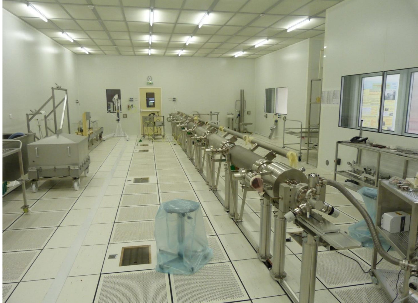
Premier train de cavités assemblé en salle blanche ISO4 (classe 10)
