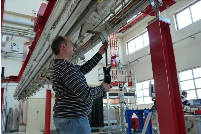
Alignement des cavités par LaserTacker
