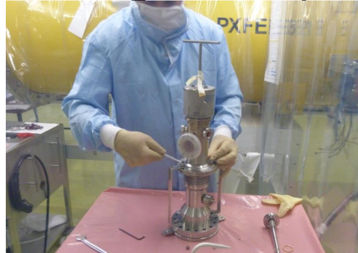
Montage des coupleurs sous flux laminaire ISO5
