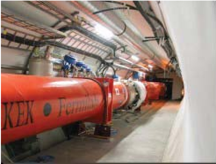
Aimants focalisant les faisceaux au voisinage des points de collision
