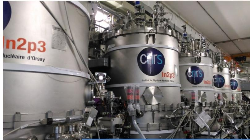
Cryomodules de SPIRAL2 (GANIL)
