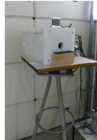
Mesure du spectre des neutrons par temps de vol (détecteur He à 8m40)
