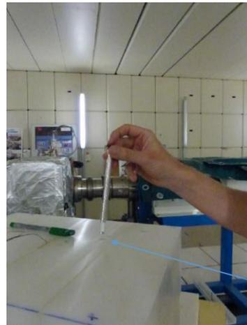
Mesure du flux dans le modérateur par activation de pastilles d'Or (10 min d'irradiation)
