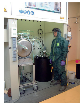
Salle de chimie où sont traitées par circulation d'acide, les surfaces des cavités afin que celles-ci ne présentent aucune altération susceptible d'engendrer des émissions parasites d'électrons.
