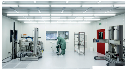
Salle blanche, équipement de très haute technologie (80 m 2 , dont 50m 2 en ISO4), maillon indispensable au nettoyage et au montage des cavités supraconductrices.
