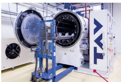
Four sous vide, dédié au traitement thermique des cavités T max: 1300 °C.
