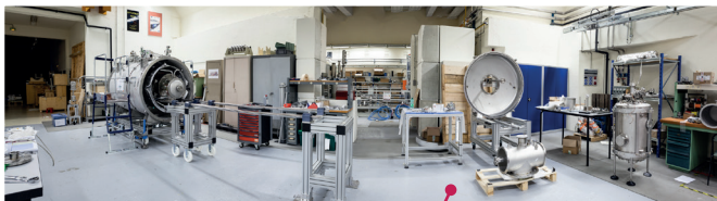
Hall de montage, zone dédiée à l'intégration des cavités dans les cryostats.
