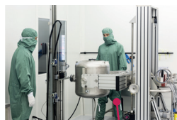
Salle blanche, équipement de très haute technologie (80 m 2 , dont 50m 2 en ISO4), maillon indispensable au nettoyage et au montage des cavités supraconductrices.
