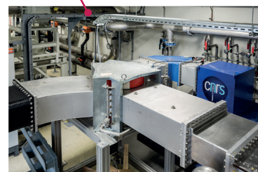
Plusieurs sources de puissance aux fréquences de 88 MHz, 350 MHz et 700MHz dont un Klystron de 2,8 MW.
