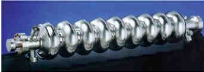
Cavité supraconductrice à neuf cellules (niobium)
