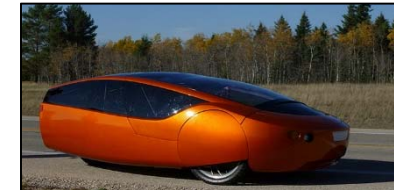
Véhicule hybride électrique. Tout en I3D (ABS), à l'exception du châssis et du moteur
