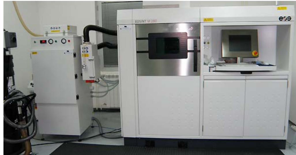
Machine à fusion des métaux EOS M280
