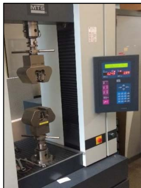
Machine de traction MTS-30M de 150 kN
