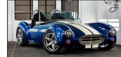
I3D mélange ABS-carbone Poids divisé par 2
