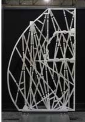
Paroi d'Airbus A320 optimisée pour l'I3D
