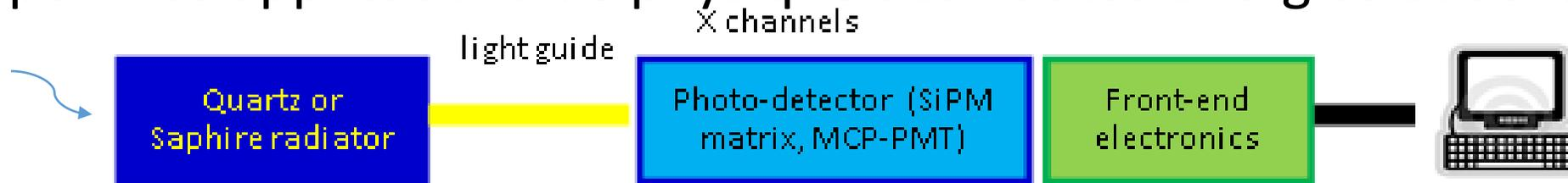
La particule incidente qui traverse le radiateur interagit avec le matériaux, produisant de la lumière alors détectée par un photo-detecteur
