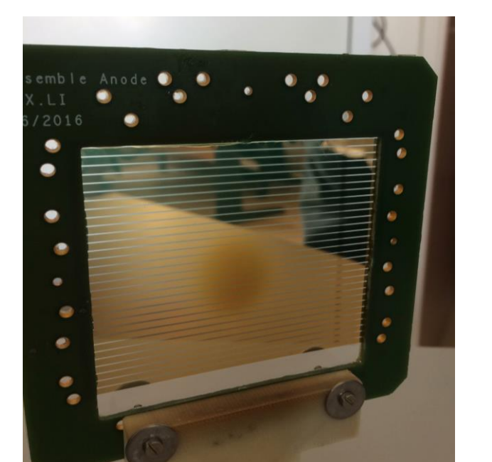
Electrode irradiée en e^- à 2 MeV au LSI : 25 \mu\text{A} pendant 25 h, 10^9 Gy
