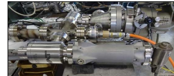
Montage de mesure de taux de dégazage du BPM
