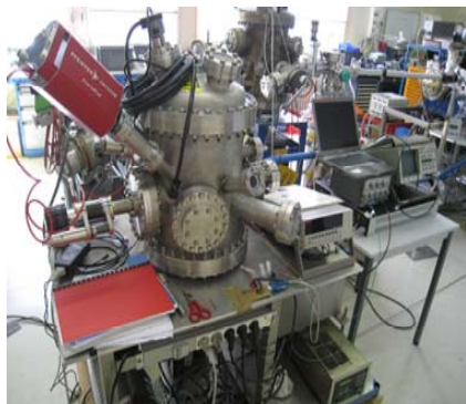
Bâti mesure SEY
