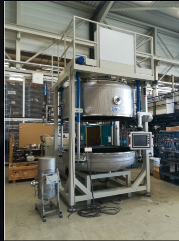
four pour fondre 500 kg d'alumine
