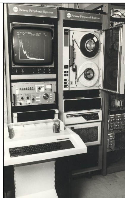
Le stockage des données par un système original à l'époque associant une bande magnétique autonome et un contrôle par un PDP11, un des premiers petits ordinateurs.
