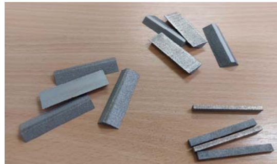
Echantillons envoyés à la société Hydrochem pour tester les traitements aux acides
