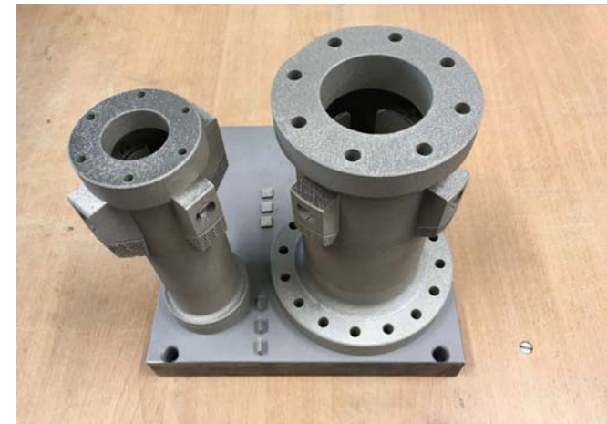
BPM et échantillons sur le plateau de fabrication chez le sous-traitant
