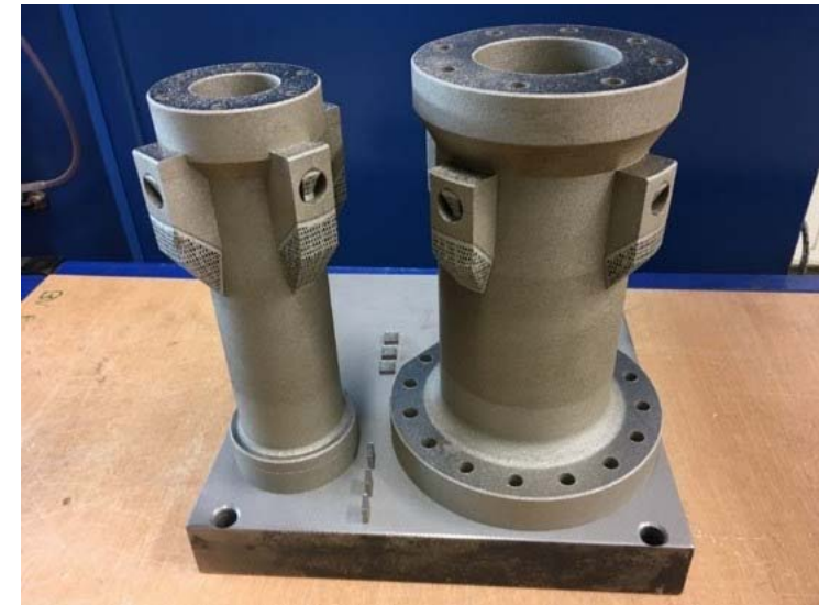
Pièces et échantillons en inox 316L sur le plateau de fabrication chez le sous-traitant (procédé SLM)
